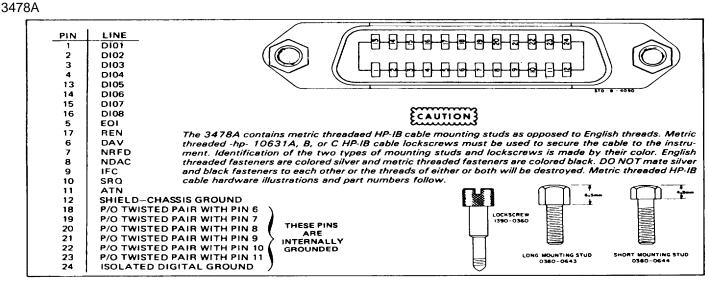
Figure 2-5. HP-IB Connector
