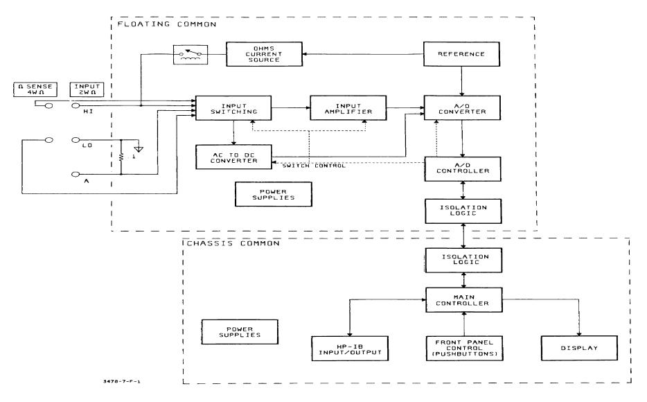
Figure 7-G-2. 3478A Block Diagram
